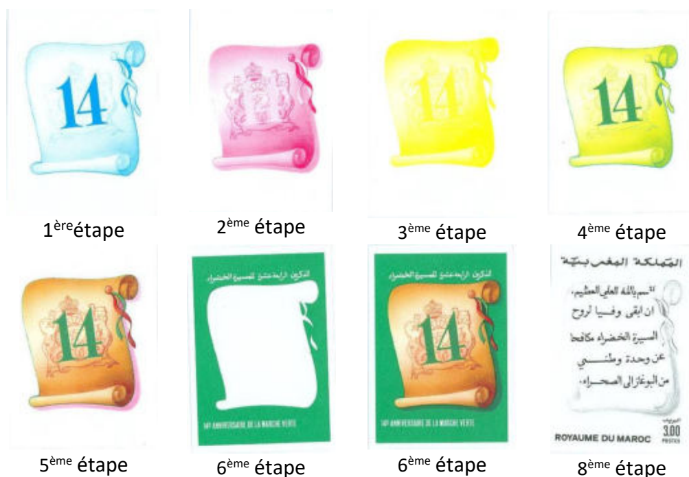
Étapes de fabrication de timbre par la technique de l'héliogravure
